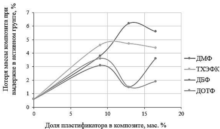
Рис. 3. Зависимости потери массы композита (при выдержке в активном грунте 120 суток) от типа пластификатора и его доли
