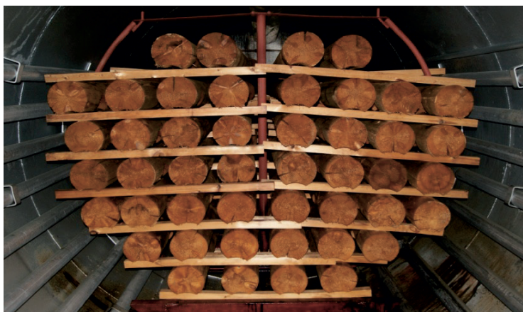
Рис. 11. Вакуумная камера термомодификации оцилиндрованных бревен для сруба (Фирма «ВакуумПлюс»)
