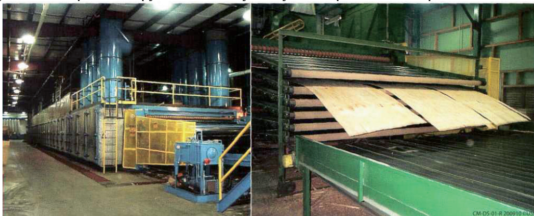
Рис. 7. Роликовая паровая сопловая сушилка шпона
