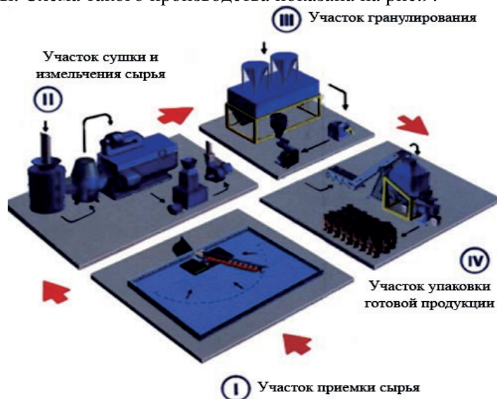
Рис. 9. Принципиальная схема завода по производству топливных гранул
