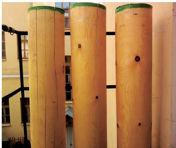
Рис. 5. Фотография образцов бревен после испытаний (слева направо: образец необработанный лакокрасочным материалом, образец с двухслойным покрытием, образец с трехслойным покрытием)
