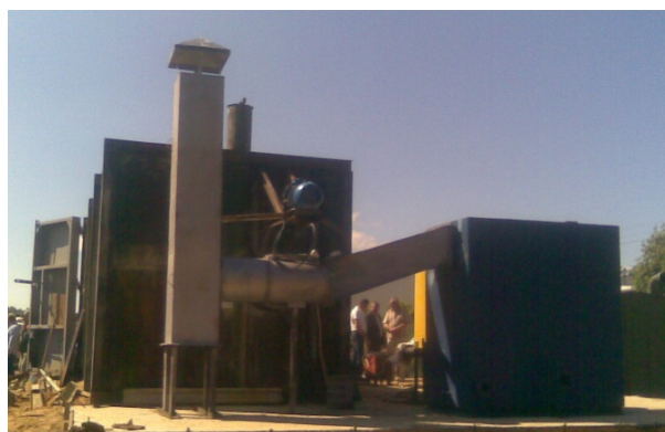
Рис. 1. Промышленная установка по термическому модифицированию древесины в среде топочных газов: а – схема установки; б – внешний вид установки.
