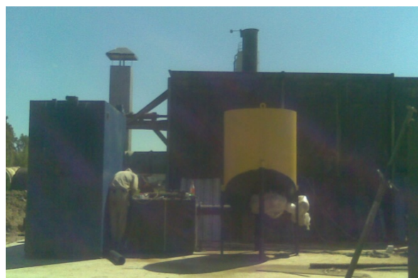
Рис. 1. Промышленная установка по термическому модифицированию древесины в среде топочных газов: а – схема установки; б – внешний вид установки.
