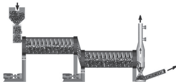
Рис. 1. Схема каскадного шнекового реактора Энергетического исследовательского центра Нидерландов (Energy Research Centre of the Netherlands) [2]
