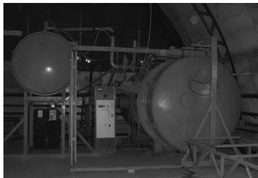
Рис. 6. Общий вид и схема промышленной установки по термомодифицированию древесины в среде перегретого пара: 1 – обечайка; 2 – крышка; 3 – камера термообработки; 4 – ТЭН; 5 – вентилятор; 6 – парогенератор; 7 – конденсатор; 8 – вакуумный насос; 9 – перфорированные сетки; 10 – пиломатериал; 11 – напускной клапан
