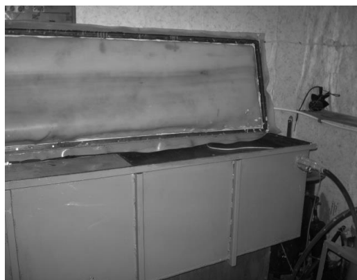
Рис. 1. Общий вид и схема пилотной пресс-вакуумной установки сушки и термомодифицирования пиломатериалов: 1 – герметичная камера; 2 – крышка; 3 – кожухо-трубчатый конденсатор; 4 – вакуумный насос; 5 – пиломатериал; 6 – нагревательные плиты; 7 – модуль управления и регистрации данных; 8 – манометр; 9 – напускной клапан; 10 – парогенератор
