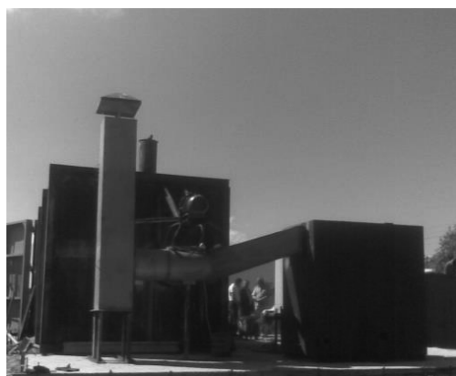
Рис. 5. Общий вид и схема промышленной камеры термомодифицирования древесины в среде топочных газов: 1 – теплоизолированная металлическая камера; 2 – створки; 3, 4 – газоходы; 5, 6 – шибберные заслонки; 7 – фальш-пол; 8 – фальш-потолок; 9 – центробежный вентилятор; 10, 11 – эжектирующие устройства; 12 – пиломатериал; 13 – топка; 14 – газоход; 15 – специальный кожух-улитка; 16, 17 – выходные патрубки; 18 – форсунки водопровода
