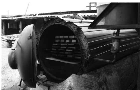
Рис. 4. Общий вид и схема пилотной установки по термомодифицированию древесины в среде топочных газов: 1 – обечайка; 2 – крышка; 4 – бак с водой; 5 – пиломатериал; 6, 8 – экраны; 7 – вентилятор; 9 – нагнетающий вентилятор; 10 – теплообменник; 11 – топка; 12 – выхлопная труба
