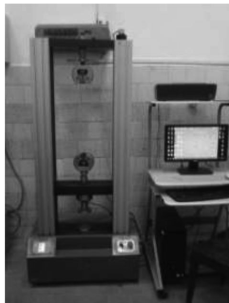
Рис. 3 Схема (а) и внешний вид (б) многофункциональной разрывной машины ИР 5082-50: 1 – станина; 2 – рама; 3 – подвижная траверса; 4 – неподвижная траверса; 5 – датчик силоизмерительный; 6 – датчик перемещения; 7 – штанга; 8 – штанга крепления активного захвата; 9 – ограничитель хода траверсы; 10 – верхний упор хода траверсы; 11 – нижний упор траверсы; 12 – универсальные захваты; 13 – приспособление «на сжатие»; 14 – приспособление «на изгиб»; 15 – переменное электрическое питание от сети (220 В); 16 – выключатель; 17 – автоматическое выключение – кнопка «СТОП»; 18 – персональный компьютер (ПК)
