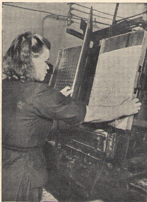
Рис. 3. Мастерница правой рукой задвигает кассету и одновременно левой рукой закрывает магазин
