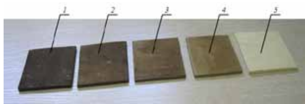
Рис. 2. Образцы трехслойной фанеры, изготовленные из термомодифицированных листов шпона: 1 – T_{обр} = 573\text{K} ; 2 – T_{обр} = 513\text{K} ; 3 – T_{обр} = 493\text{K} ; 4 – T_{обр} = 573\text{K} ; 5 – контрольный.
