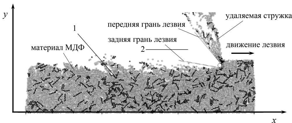
Рис. 1 – Модель структуры плит МДФ: 1 – микрослой МДФ; 2 – резец фрезы
