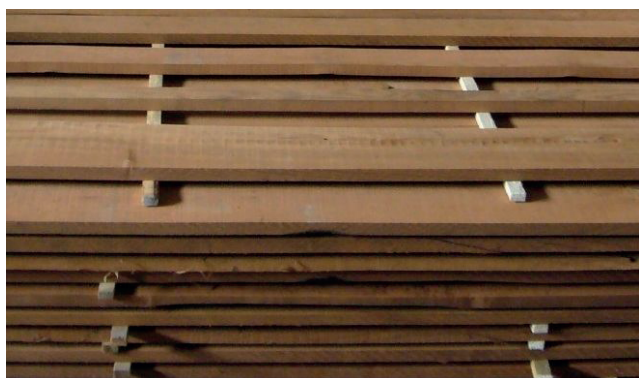
Рис. 4. Изменение цвета ясеневой древесины после ТО
