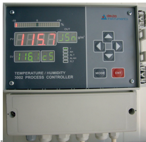
Рис. 3. Контроллер для управления автоклавом для пропаривания древесных сортиментов
